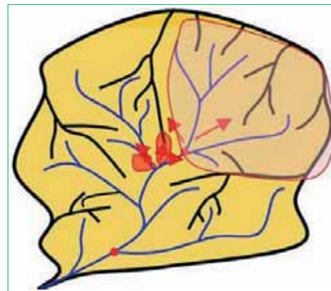
Figura 94. Aquest esquema es denomina "propagació per fons de barranc" (g) i es replica fins arribar a la capçalera de la vall o conca hidrogràfica. En el cas d'una vall complexa amb ramificacions laterals, l'esquema es multiplica a cada nus de barranc o confluència de valls secundàries, ampliant la superfície afectada per l'abast de l'incendi. Font: Bombers Generalitat Catalunya.
