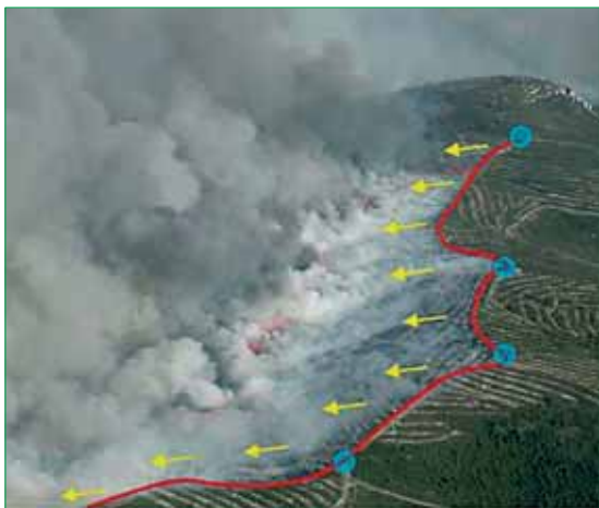
Figura 131. IF Alcover 5/08/2003. Utilització de pista (vermell) com a línia d'ancoratge per realitzar un atac paral·lel (groc) per confinar i definir el flanc. En blau zones segures. Font: Bombers de la Generalitat de Catalunya.
