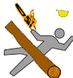
En el desbrancatge cal preveure els moviments sobtats de l'arbre.
