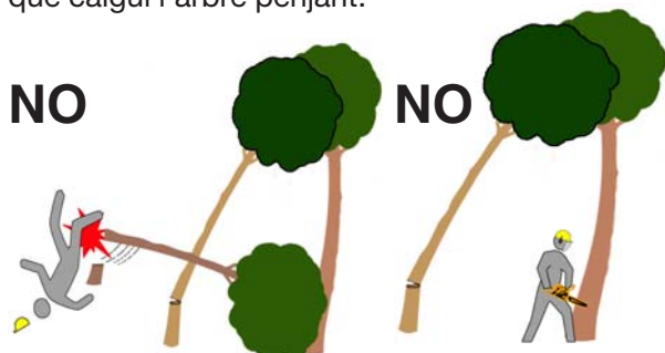
No s'ha de fer caure un altre arbre sobre l'arbre penjant.
