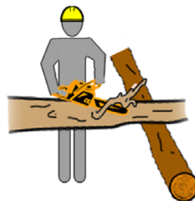
Cal col·locar-se al costat oposat de la branca que s'ha de tallar.
